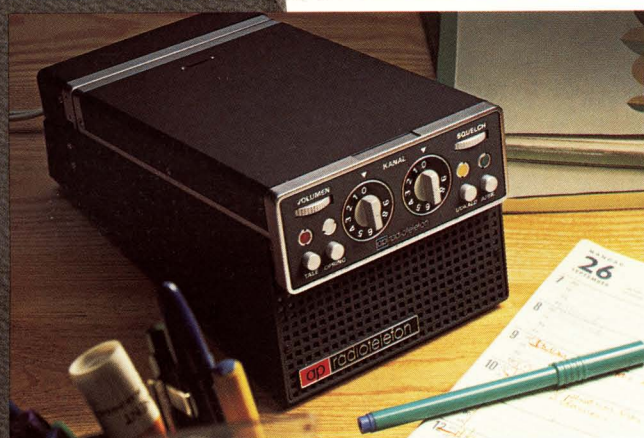
AP 2000 kan benyttes som hovedstation, når den placeres i en hovedstationskassette med indbygget højttaler og mikrofon. Denne kassette kan også loftmonteres i lastbiler.
